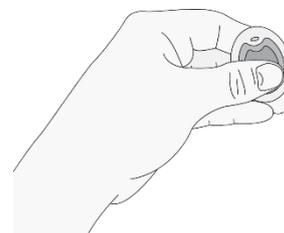
**Etape 4** – Appuyez sur le bouton d'annulation vert puis relâchez-le. L'unité d'alarme émet un bip et est à nouveau en mode veille pour les appels d'aide. La LED rouge du bouton d'alarme est allumée en permanence et la petite LED est verte.
