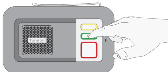
**Etape 3** – Appuyez sur le bouton d'alarme de l'émetteur dans les **2 secondes**. Lorsque la voix est activée, l'unité d'alarme indique le type d'émetteur pour confirmer la réception, sinon, vous entendez un bip.
