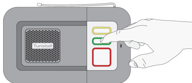
**Etape 5** – Testez l'émetteur en l'activant et en vérifiant si un appel d'aide est en cours. Si cela ne fonctionne pas, assurez-vous que l'appareil est au repos et réessayez.
